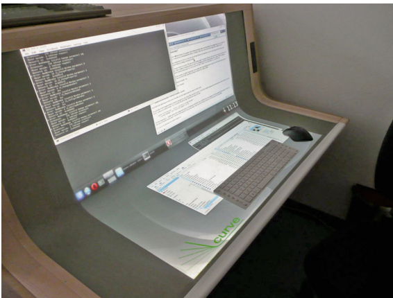
Abb. 2 Der Curve, ein großes gebogenes Display als spezialisierter Arbeitsplatz für verschiedene Aufgaben (Bildquelle: [17])
