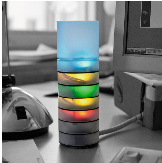
Abb. 7 StaTube ist ein interaktives Objekt für Periphere Interaktion: Durch Drehen des Kopfteils wird der eigene Skype-Status verändert (Bildquelle: [4])
