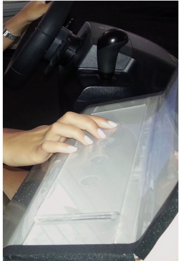
Abb. 1 Interaktion mit der strukturierten Mittelkonsole: Das Display kann ertastet und damit teilweise blind bedient werden
