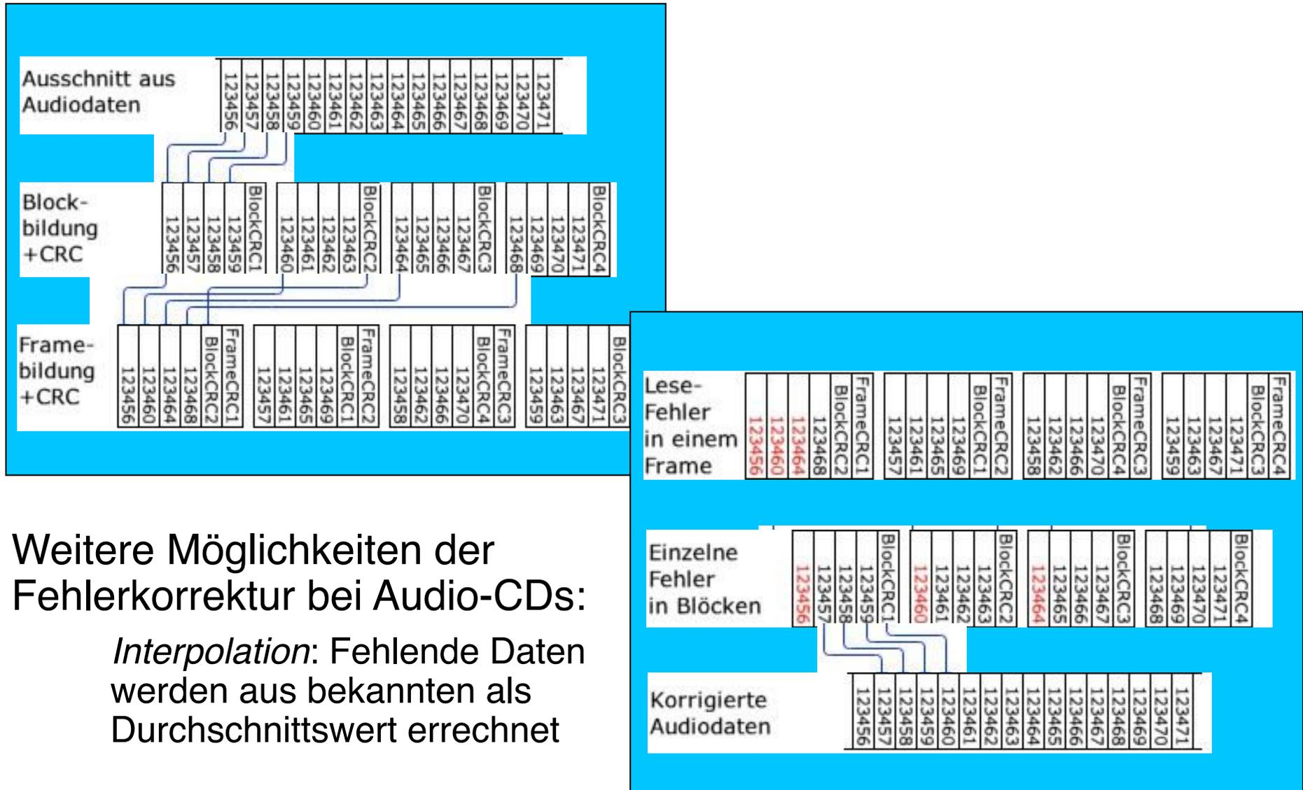
Weitere Möglichkeiten der Fehlerkorrektur bei Audio-CDs:
