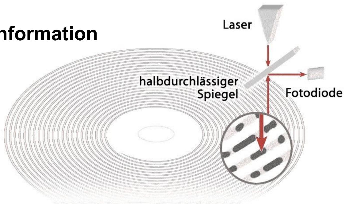
Laserstrahl nahe dem Infrarot-Bereich (AlGaAs), Wellenlänge 780 nm
