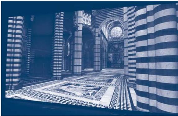
**Abb. 6 48 Projektor/48 PC HeyeWall, 6000×3000 Pixel Auflösung. (Bild Fraunhofer IGD)**
