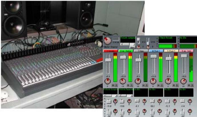
**Abb. 3: Grafische Oberfläche eines virtuellen Tonmischpults [7]**
