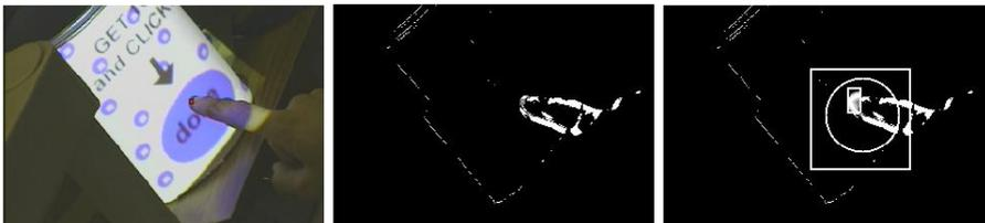
**Abbildung 7:** Ablauf einer Finger-Erkennung [8].
