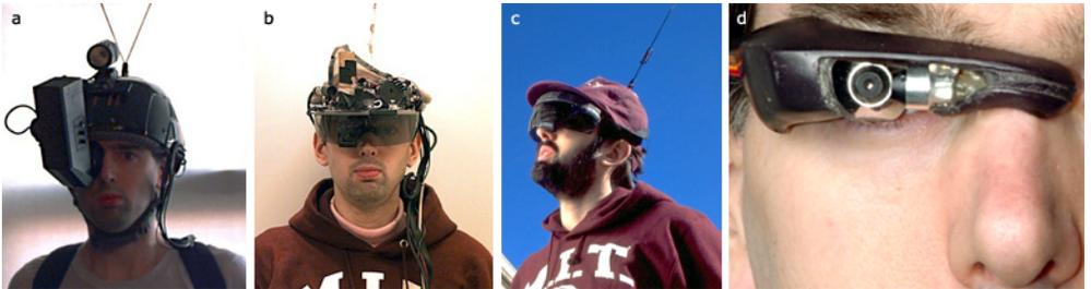
**Abbildung 11.** Entwicklung der Head Mounted Displays von Steve Mann angefangen 1980 mit dem (a) Helmdisplay inklusive langer Antennen bis hin zum (d) "EyeTap" Display (aus [10], [12])
