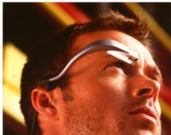
**Abbildung 12.** Minimales Head Mounted Display des IBM Wearable Thinkpad PCs (aus [14]).
