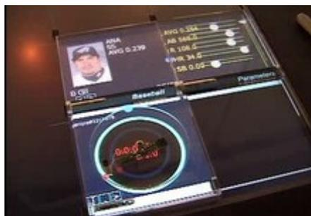
Abb. 10: Funktionskachel mit zwei anliegenden Parameterkacheln [23]
