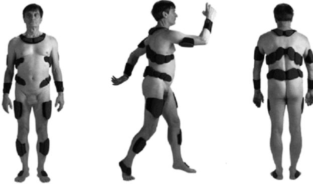
**Abbildung 6.** Dynamische, dreidimensionale Objektformen, die auf Basis der aufgestellten Richtlinien für Wearability von der Forschungsgruppe entwickelt wurden (aus [4]).
