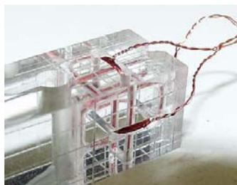
Abb. 5: Magnetischer 3D Sensor [16]
