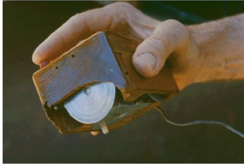
**Abb. 1: Prototyp der Computermaus [2]**
