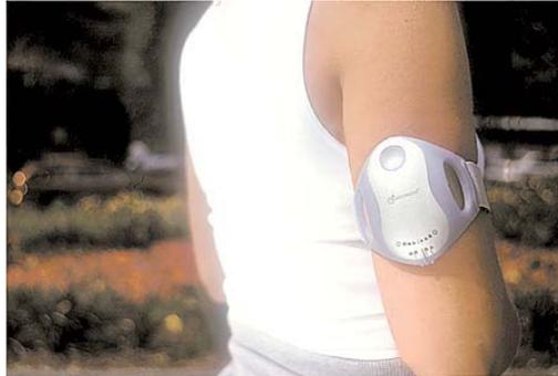
**Abb. 3** SenseWar, drahtloses Sensorgerät zur Messung der Körperfunktionen [2].
