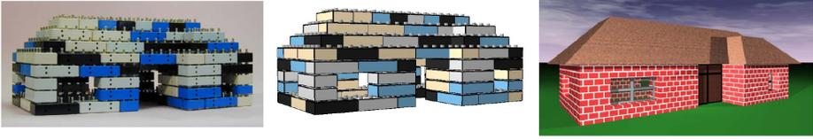
**Abbildung 13.** Intelligente Bausteine: Das reale Modell, die Darstellung der Strukturdaten im Computer, vom Computer berechnete Erscheinungsergänzung [7].
