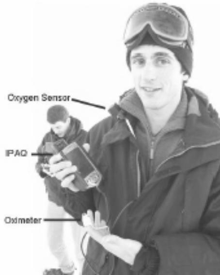
**Abb.4:** Prototyp mit Beschleunigungssensor und Biosensor. Quelle [5]
