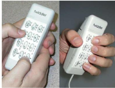
**Abbildung 2.** Twiddler-Tastatur. Links als MutiTab, rechts als Chording
